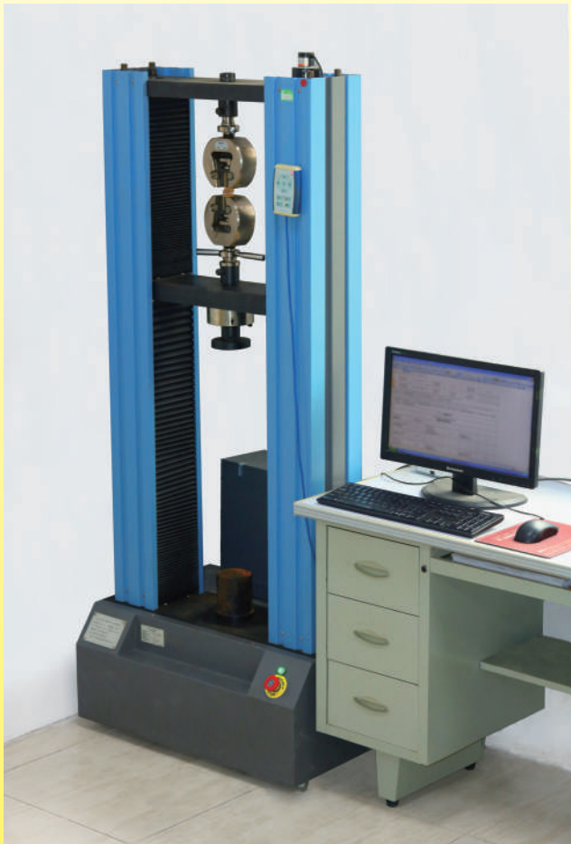
Прочность на разрыв и удлинение при разрыве оборудования
